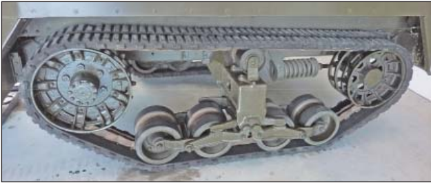
18. ábra. Az M3-as USA féllánctalpas (gumihevederes) futóműve
