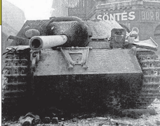
14. ábra. A budapesti harcok után Pesten, a Dobozi és Magdolna utca sarkán maradt vadászpáncélos, mágneses aknáknak elleni „zimmerit” bevonattal, előtte a kilőtt löszerek hüvelyeivel
