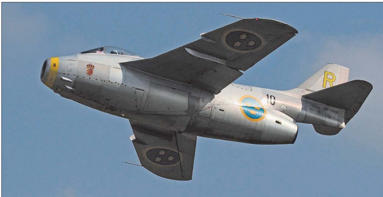
3. ábra. A J-29 Tunnan sárkányának hátsó része hasonlít a TS-11 Iskra lengyel gyakorló repülőgép hátsó részére. Alul a gázturbina kiömlő nyílása, felette függőleges és vízszintes vezérsíkot tartó törzs-hátsórész
