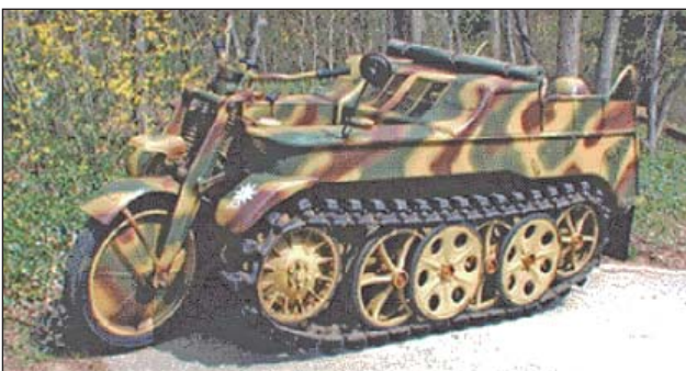
19. ábra. Sd.Kfz 2-es kis méretű láncctalpas katonai motorkerékpár, a Kettenkrad alapváltozata
