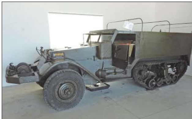
17. ábra. M3 USA féllánctalpas szállító jármű alapváltozata
