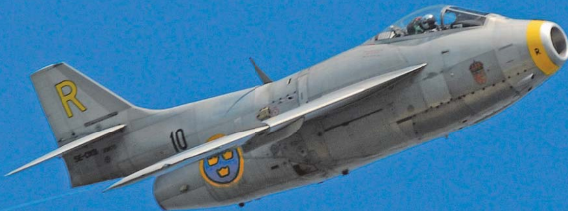
1. ábra. A J-29-es Tunnan 32,1 m/sec emelkedési sebessége elérte az 1950-es évek legjobb vadászipülölgépeinek képességét
