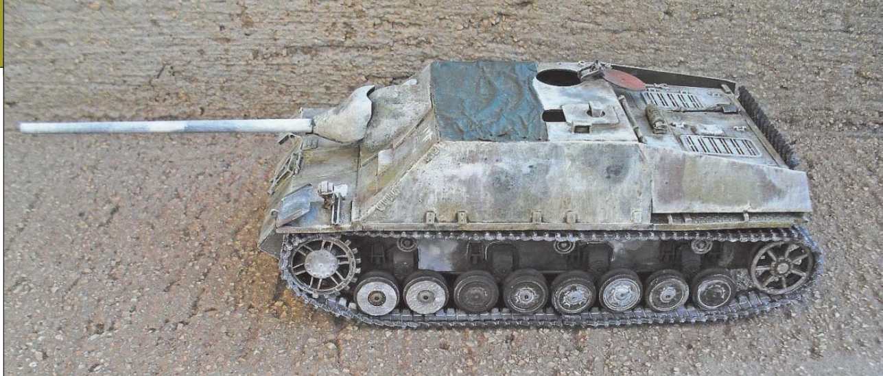
7. ábra. Késői gyártású, zimmerit nélküli, hátul vízszintes kipufogóval szerelt, a magyarországi hadszíntéren 1944/45 telén lefényképezett Jagdpanzer IV L/70 vadászpáncélos egyedi építésű 1:35-ös makettje (Makett: Tolnay Trisztán Péter)
