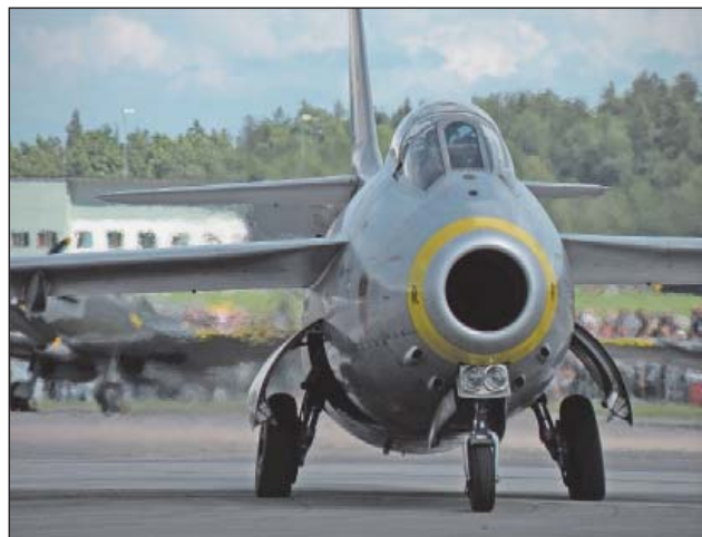
4. ábra. Előlről a J-29 Tunnan. A gépágyú nagy tűzerőjű harci repülőgéppé tette, a pilóta kilátása is megfelelő volt
