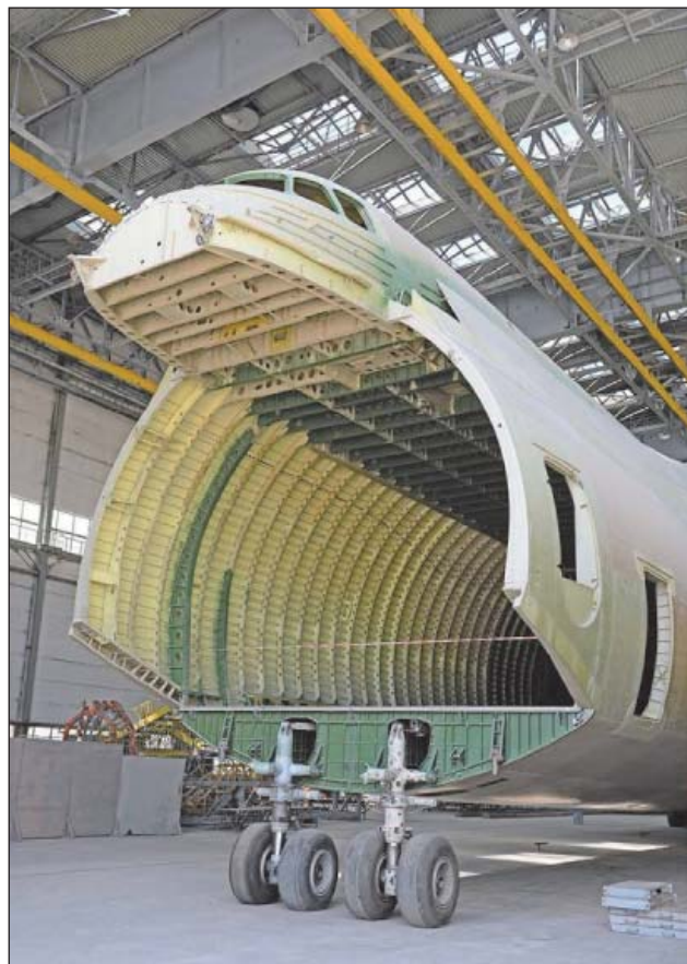
12. ábra. Az Antonov An-225-ös szállító repülőgép orrfutó szekciója és a törzsor
