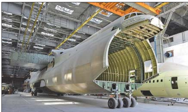
10. ábra. Az Antonov An-225-ös szállító repülőgép törzse előlről
