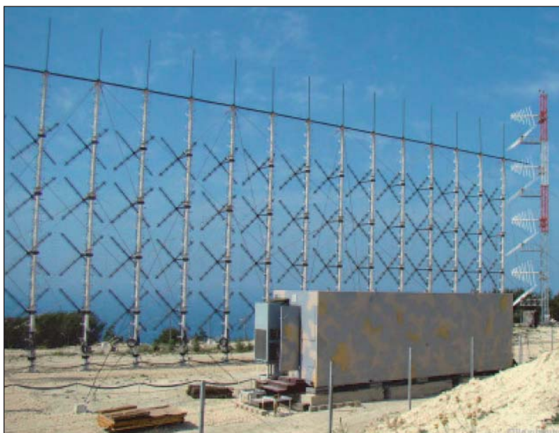
10. ábra. A RESONANS orosz távfelderítő VHF radar [8]
