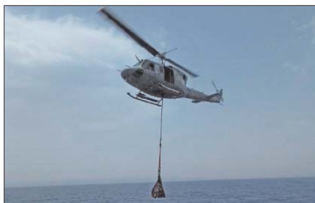
3. ábra. Augusta-Bell könnyűhelikopter külső teheremeléssel szállít ellátmányt az EUNAVFOR MED misszióban
