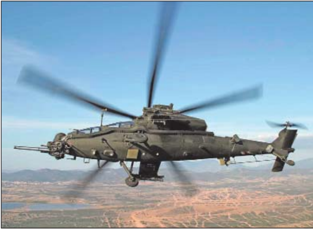
2. ábra. Az A-129-es MangustaCBT fordulékony, mozgékony helikopter, amely elsősorban viszonylag könnyű szerkezete, és az erős Allison Allied Signal T-800-as gázturbina eredménye
