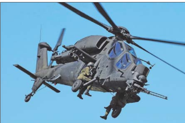
3. ábra. Az A-129-es a kétfős személyzet mellett nem alkalmas személyszállításra, de kényszerűségből két fő a kereken függeszkedve, rövid távon szállítható
