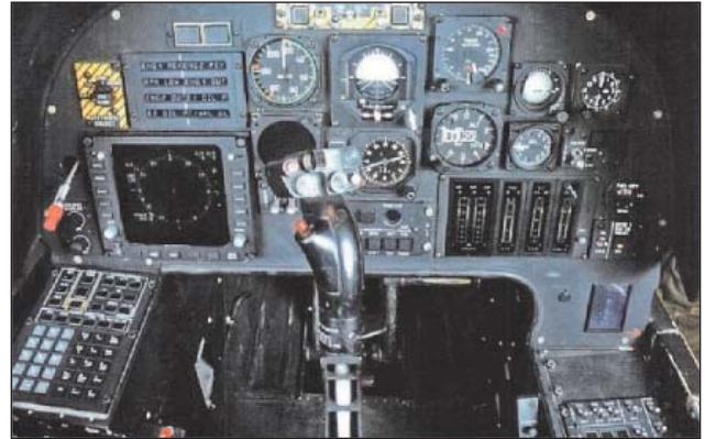
4. ábra. Az A-129CBT változat vegyes analóg és digitális műszerezettségű fülkéje
