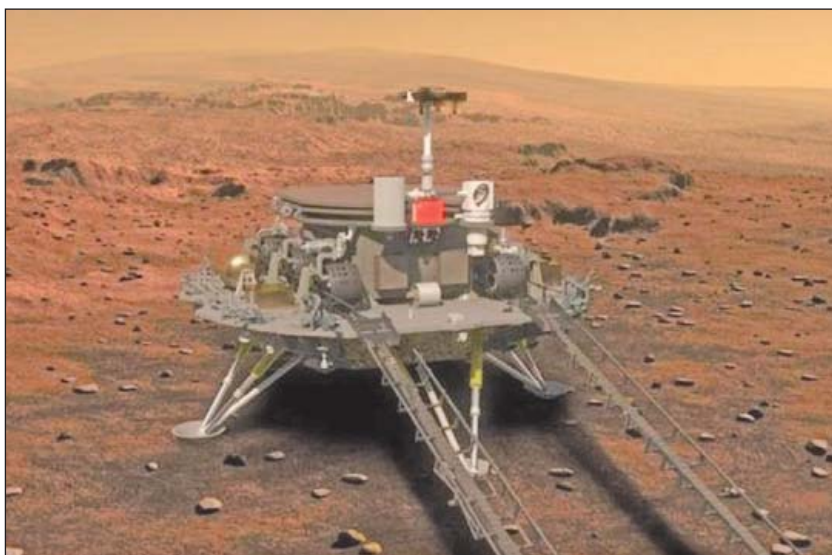
12. ábra. A leszállóegység a „hátán” szállítja a Mars-járó berendezést
