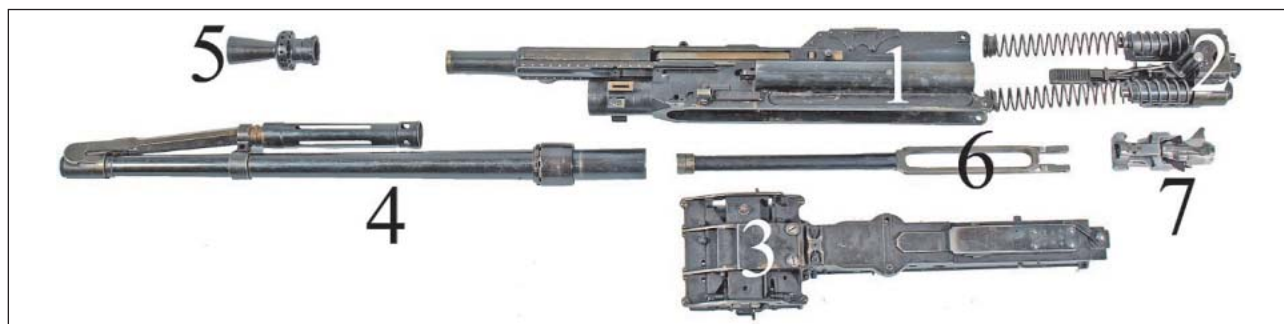
44. ábra. A 20 mm-es nehéz géppuska fő részei
