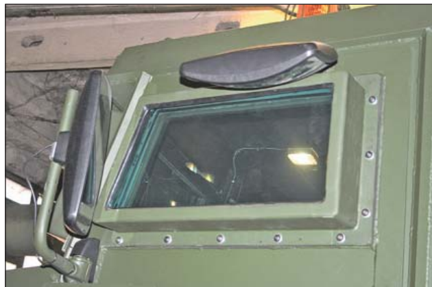
13. ábra. Az elhelyezett tükrök nagymértékben segítik a kilátást és a tájékozódást (HM CURRUS Zrt.)
