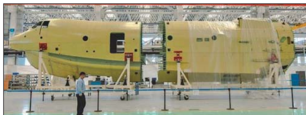
4. ábra. A törzsszekciók összerakása
