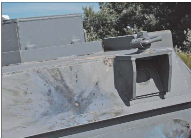
18. ábra. Sikertelen találat a ballisztikai védelmi képesség próbáján (HM CURRUS Zrt.)
