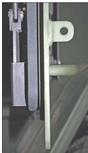
14. ábra. Az ajtók ballisztikai védőrendszere jól látható a képen. A megnövekedett tömeg miatt erősebb zárszerkezetre van szükség (HM CURRUS Zrt.)
