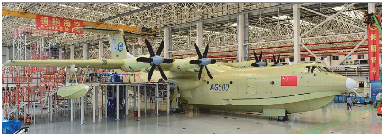
5. ábra. Jól láthatók a stabilitásért felelős segédúszók
