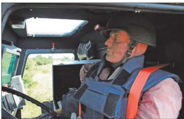
19. ábra. Az akna elleni védelmi képesség próbája alkalmával próbababút alkalmaztak a kezelőszemélyzetre gyakorolt hatások vizsgálatához (HM CURRUS Zrt.)
