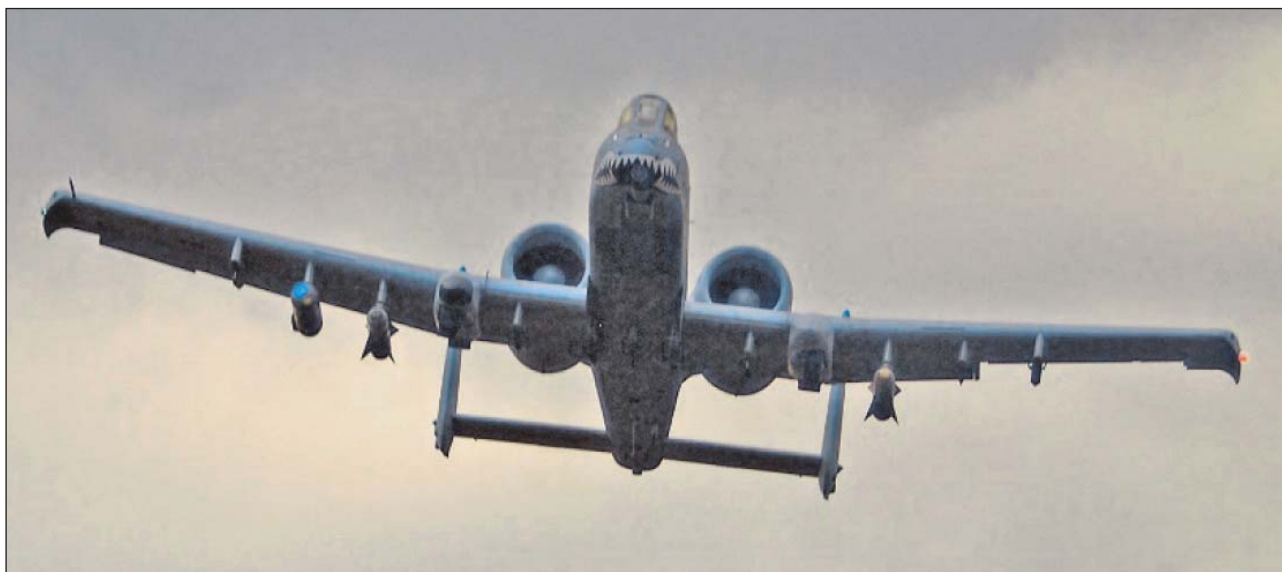
19. ábra. A-10C, orr-részében a 30 mm-es gépágyúval
