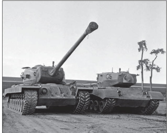
6. ábra. Megkésett trónkövetelők. A balra látható T29-es mellett egy ritka felvétel a hegesztett testű T32E1-esről. A torony hátulján lévő furcsa alakzat ellensúly a hosszú ágyúhoz
