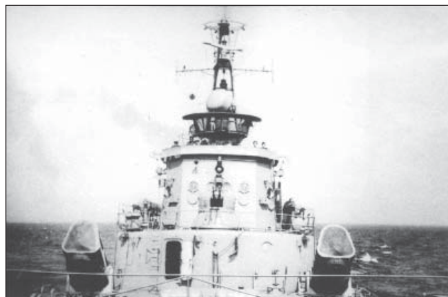
23. ábra. Partvédő hajó a korai robotrepülőgépek konténereivel
