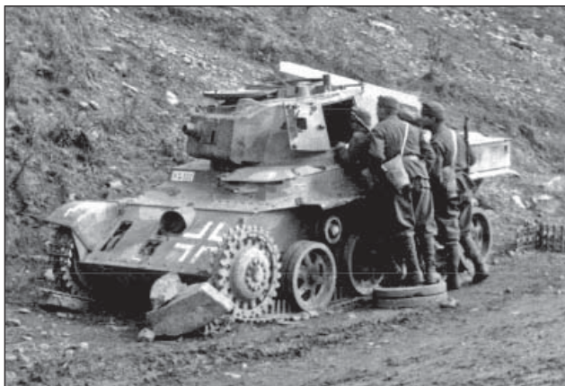
6. ábra. A H-322-es rendszámú, aknára futott 38M Toldi könnyű harckocsi, kisserelt fegyverzettel
