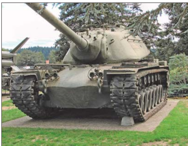
8. ábra. Nehéz, lassú és nagy fogyasztású, viszont nagy teljesítményű ágyúja van és jó a védettsége. Évtizedes vajúdás szülöttje az M103-as nehéz harckocsi
