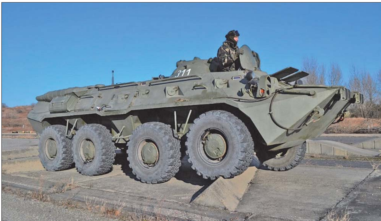
33. ábra. A 6-15203-as kerekekkel szerelt BTR-80-as harcjármű a ferde hasáb pályán
