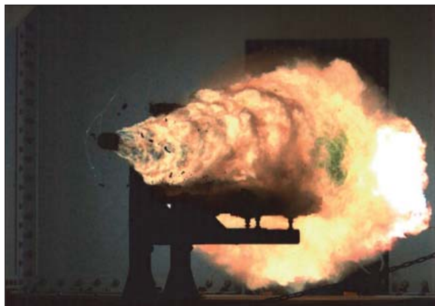
6. ábra. A 10 MJ-t túlszárnyaló rekorder lövés 2008. január 31-én (forrás: US NAVY)
