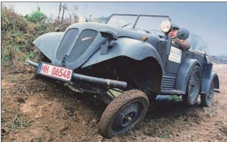
8. ábra. A független kerékelfüggesztés kedvező terepjárási tulajdonságokat biztosított
