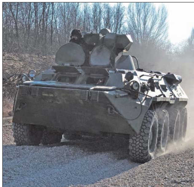
29. ábra. A 6-15203 kerekekkel szerelt BTR–80A harcjármű a kavicsos próbapályán
