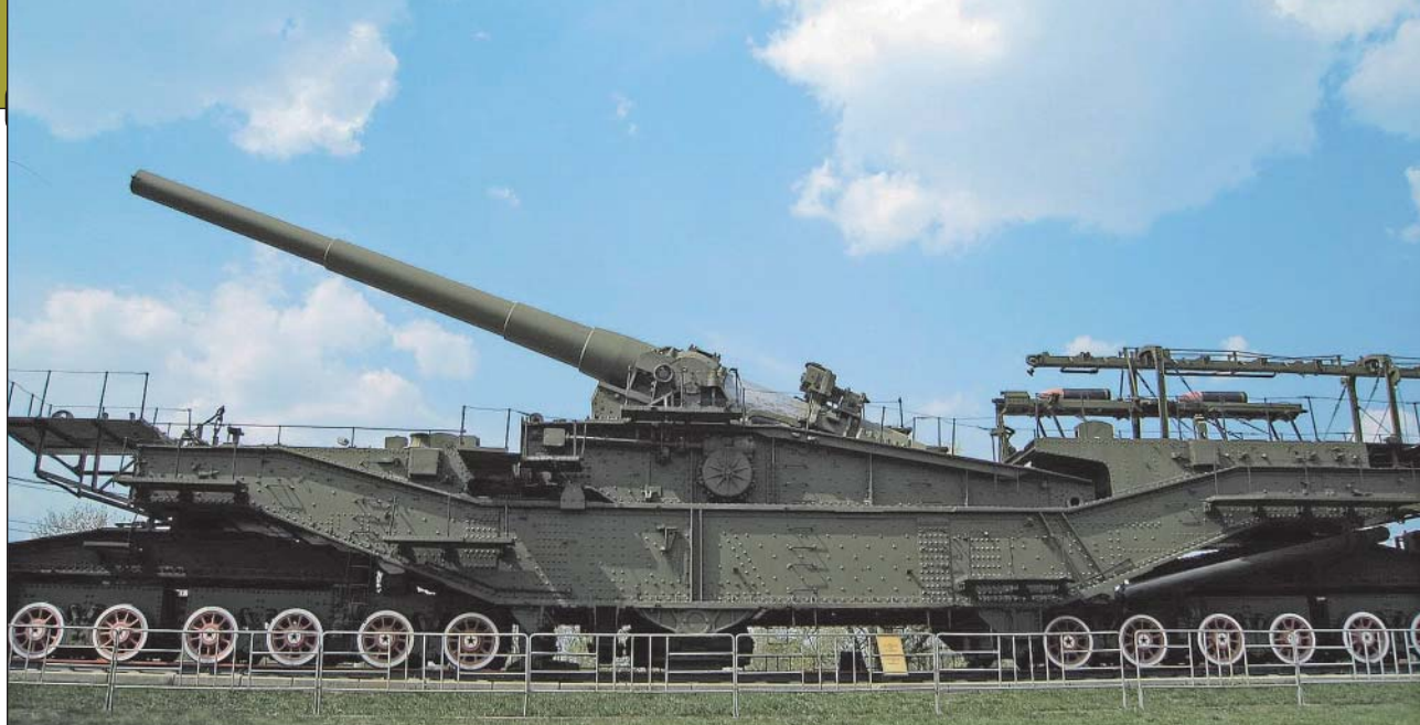
13. ábra. A szovjet TM-3-12 típusú vasúti löveg 1938-ban épült, a lebontott IMPERATOR ALEKSZANDER III. csatahajó 305 mm-es L/52-es lövegének felhasználásával
