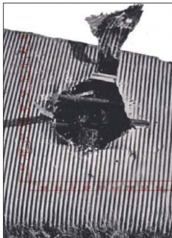
1. ábra. 20 milliméteres Madsen nehéz géppuska romboló hatása (mintegy 50 mm átmérő) alumínium repülőgépszárnyon 2
