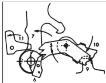
3. ábra. Elsütőszervezet szerkezeti vázlata 5. számláló, 6. kakasemelő, 7. kakas, 9. késleltető, 10. számláló késleltető, 11. kakasakasztó
