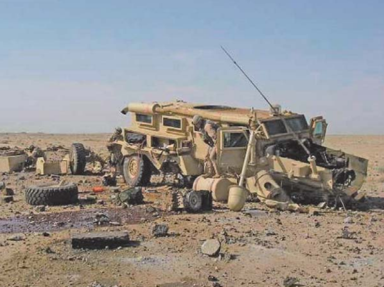
2. ábra. IED által elpusztított Cougar páncélozott harcjármű
