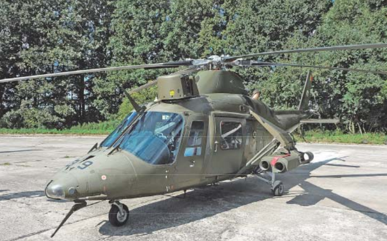
5. ábra. A belga védelmi erők az A 109LUH helikoptereket páncéltörő rakétákra is alkalmazhatják, négy páncéltörő rakétát hordozhatnak. A pilótafülke felett a rakéták irányító berendezése látható
