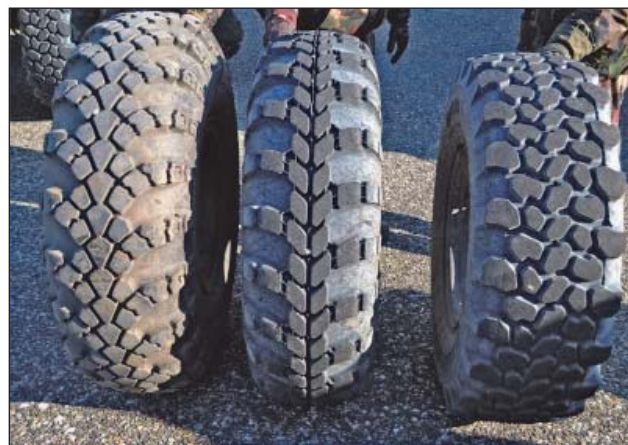
31. ábra. A KI-126 (BTR-80A), a KI-80N (BTR-80-as) és a Continental (6-15203-as) gumiabroncsok összehasonlítása
