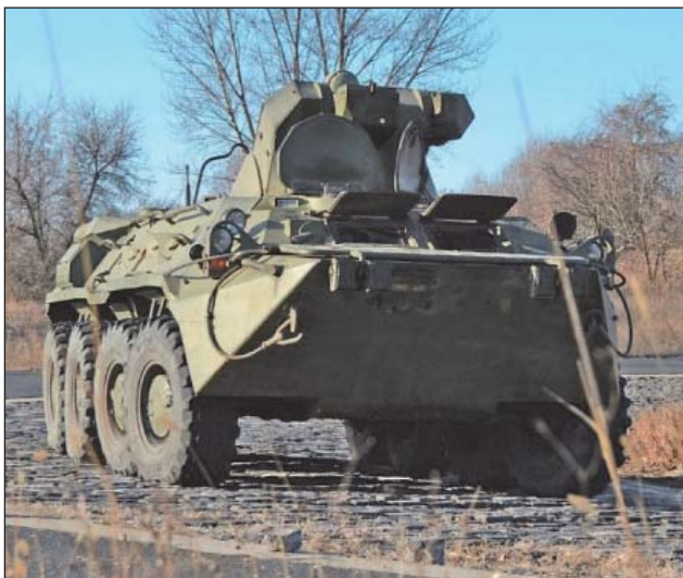
30. ábra. A 6-15203-as kerekekkel futó BTR-80A harcjármű az ún. belga út visszafordító kanyarjában
