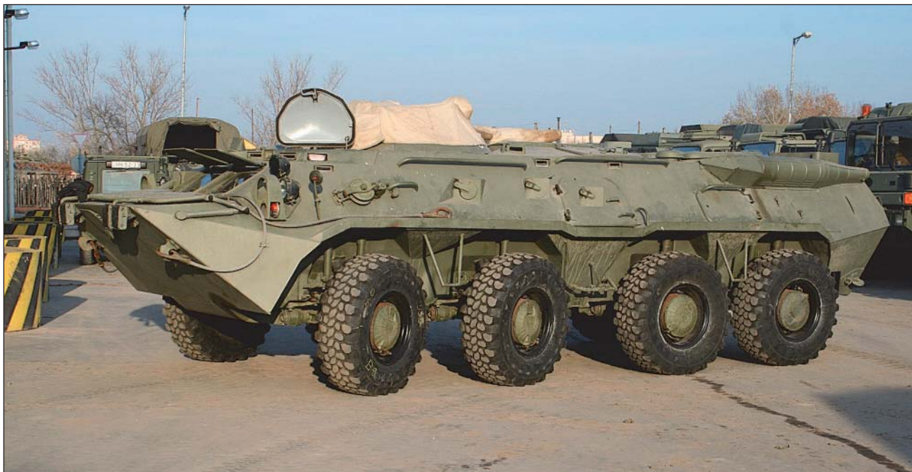
27. ábra. BTR–80 típusú harcjármű 6-15203 kerekekkel szerelve az MH 5. Bocskai István lövészdandár hódmezővásárhelyi javítóműhelye előtt
