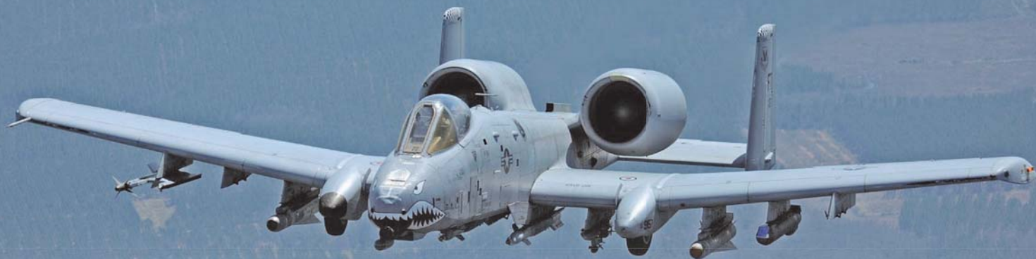
1. ábra. A-10C Warthog csatarepülőgép a levegőben. Függesztménye: célmegjelölő konténer, AGM-65-ös Maverick levegő-föld rakéta, lézervezérlésű GBU (bomba), valamint AIM-9-es Sidewinder légiharc-rakéta
