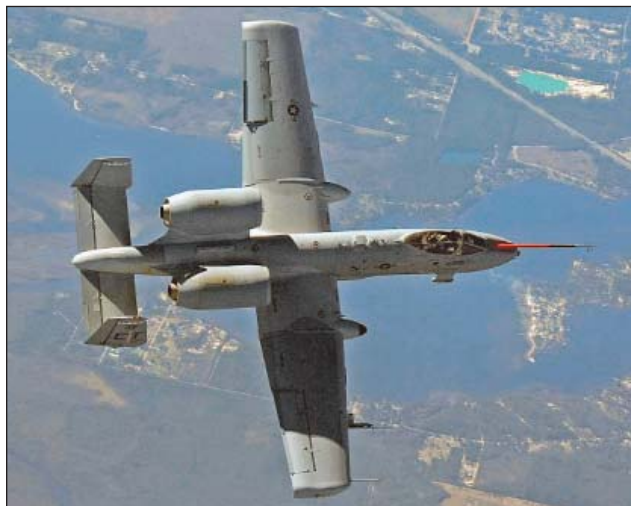
8. ábra. Az A-10-es Thunderbolt II csatrepülőgép egyik prototípusa. Az orr-részen látható pitotcső – amely a későbbi merev kialakítású légi utántöltő berendezés helyére van szerelve – a repülési próbákhoz volt szükséges, a sorozatgyártású repülőgépeken a szárnyra került beépítésre
