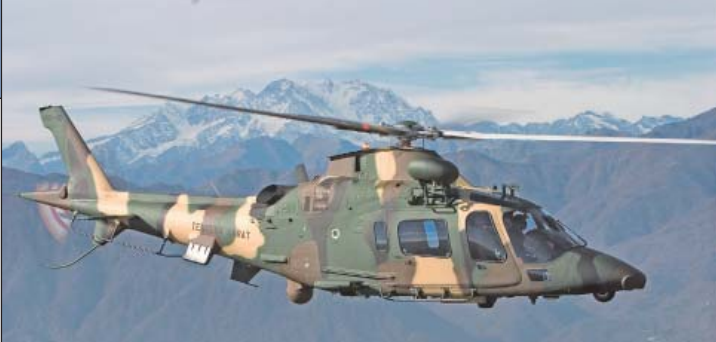
7. ábra. A Maláj Hadsereg A 109-es helikoptere repülés közben. Látható a forgószárnyas alá szerelt felderítőkupola, valamint az önvédelmi csomag besugárzás-jelzői
