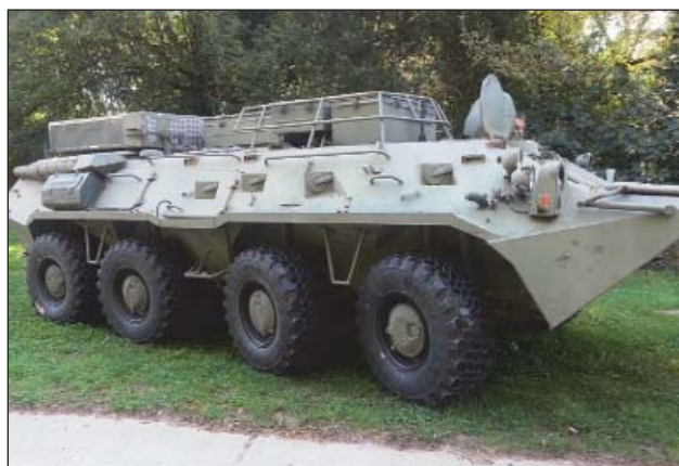
26. ábra. A 6-15203 típusú kerekek egy BTR műszaki akadályelhárító harcjárműre szerelve
