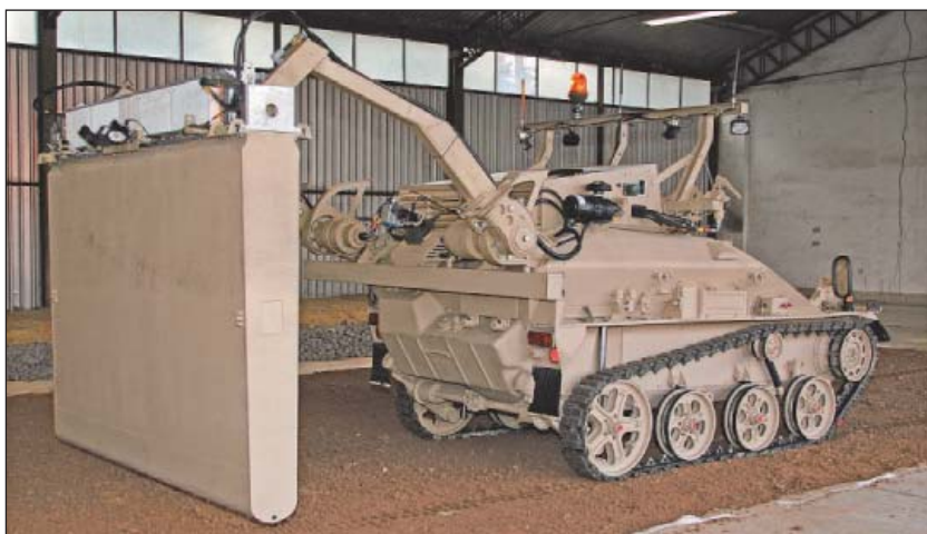
5. ábra. Talajradarral ellátott távirányítású detektorjármű, Wiesel 1-es alvázon
