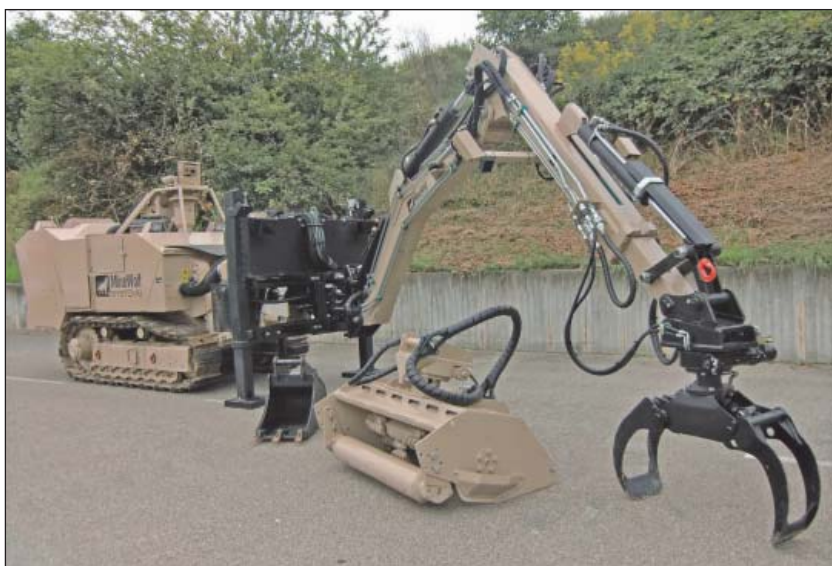
6. ábra. Mini MineWolf távirányítású manipulátor-jármű robotkarral és növényvágó szerelvénnel
