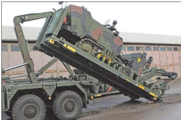
7. ábra. Mini MineWolf manipulátor-jármű rakodása
