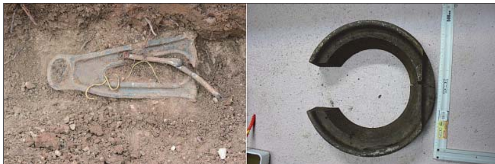
23. ábra. Motortartó (balra) és kiegyenlítő orrsúly (jobbira)
