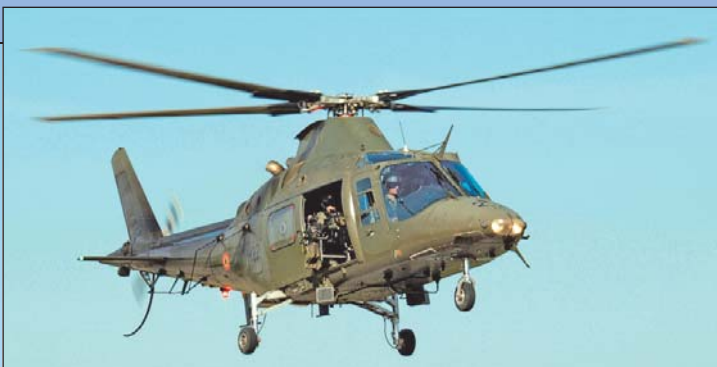
2. ábra. Lendolás közben a belga haderő A 109LUH helikoptere. A belga helikoptereknek a besugárzásjelzők mellett jellegzetessége a helikopter orr-részére és fülkéjére szerelt drót/kábelvágó
