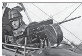
a) 1907/16 M Forgógyűrűre illesztett megfigyelő géppuska 4
