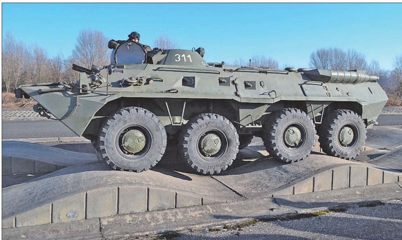
32. ábra. A 6-15203-as kerekekkel szerelt BTR-80-as harcjármű az eltolt szinusz pályán
