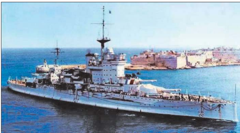
13. ábra. Az első világháborút követően átépített WARSPITE csatahajó a máltai kikötőnél. Fő fegyverzete 8 db 381 mm-es L/42-es hajóágyú volt
