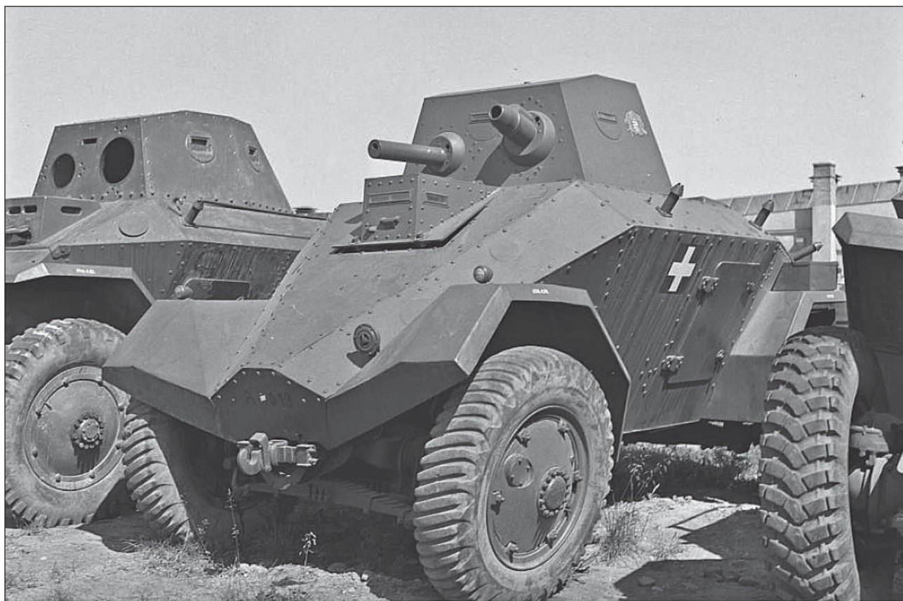
72. ábra. A kezdeti időszakban alkalmazott gumiabroncsok (balra) és az új Cordatic „sarkantyús” abroncs (jobbra) (Fortepan 72133)
