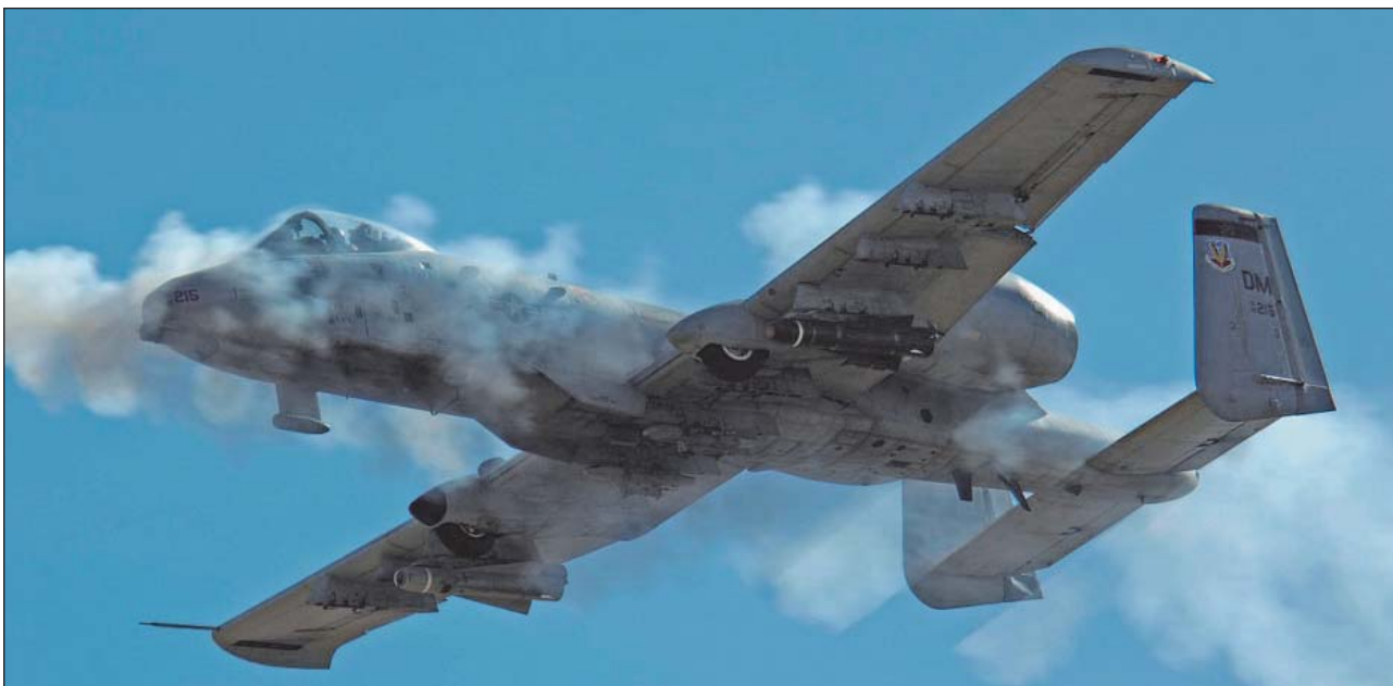
6. ábra. Az A-10-es fő fegyverzete a 30 mm-es Gatling gépágyú. A repülőgép függesztményként két darab AGM-65 levegő-föld rakétát is hordoz
