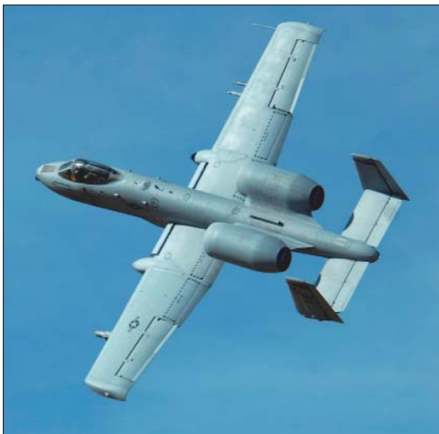
3. ábra. Az A-10C-k már légi fölény szürke festést kaptak, amely a földi vizuális azonosítást nehezíti. Jól láthatóak a törzs felső részére épített hajtóművek, amelyeket takarnak a légvédelmi eszközök elől a törzs, a szárnyak és a vezérsíkok elemei
