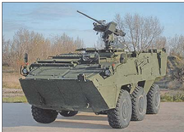
5. ábra. Kongsberg Protector távirányítású fegyverplatformmal és 12,7 mm-es géppuskával szerelt 6×6-os Pandur szállító harcjármű
