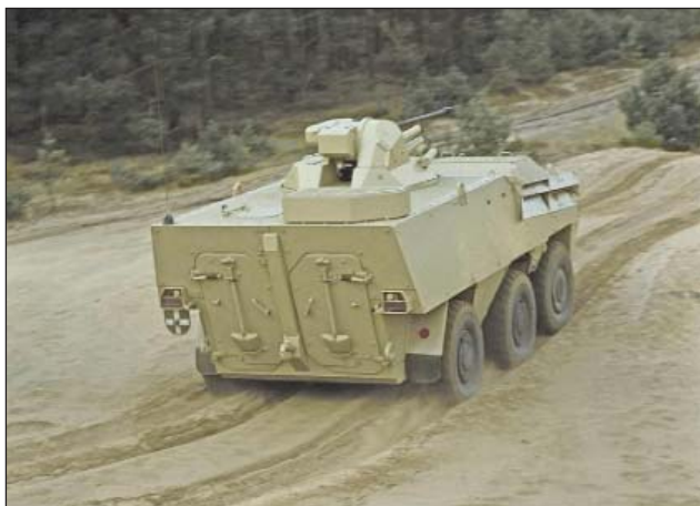
3. ábra. KD-V30-as toronnyal, 30 mm-es géppágyúval és párhuzamosított 7,62 mm-es géppuskával szerelt 6×6-os Pandur gyalogsági harcjármű homokos terepen
