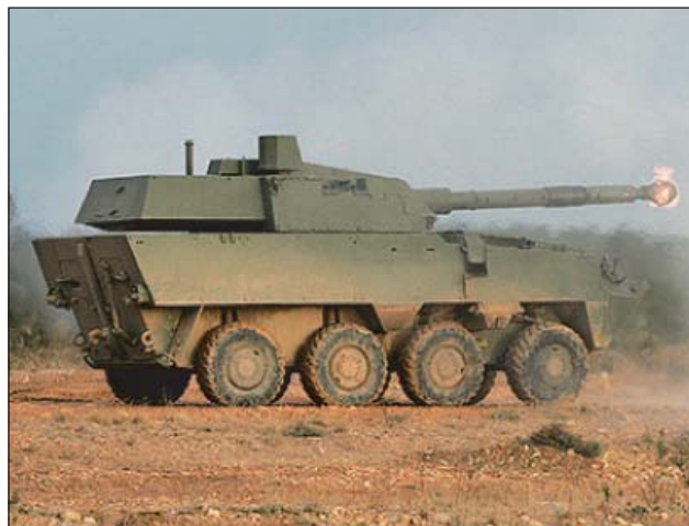
16. ábra. 8x8-as önjáró tűztámogató változat CT-CV toronnyal, 105 mm-es löveggel és 7,62 mm-es géppuskával
