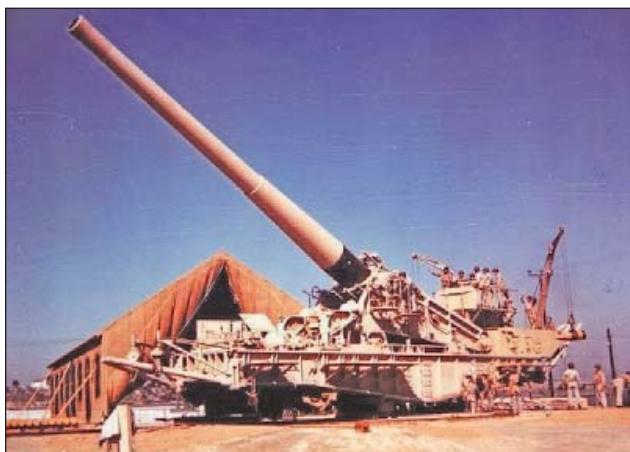
5. ábra. Az amerikai 14 inch-es (356 mm-es) 1920M vasúti ágyú 1920–1946 között volt rendszerben
