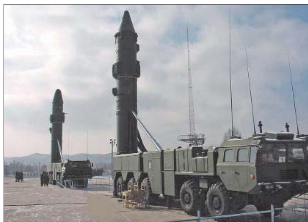
4. ábra. A DF-21C rakéták a TEL (Transporter Erector Launcher) járművön
