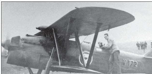
14. ábra. Az 1/5 Kör ász század gépe start előtt. A járó motor légcavarszele a szélgenerátor légcavariját is megpörgeti. A gépen felszegecscelt adattábla található a fülke kiváltás bal oldalán. A szélgenerátor az áramvonalasan kialakított, közel cseppformájú üzemanyag kiegészítő tartály elejére volt szerelve
