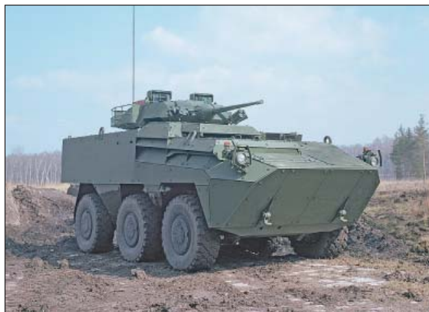
4. ábra. GD LAV 25-ös toronnyal, 25 mm-es géppágyúval és párhuzamosított 7,62 mm-es géppuskával felszerelt 6×6-os Pandur gyalogsági harcjármű
