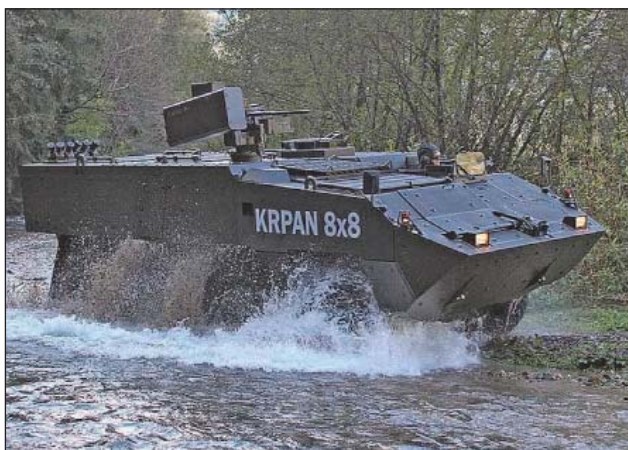
15. ábra. Licenc alapján Szlovéniában gyártott Krpan nevű gyalogsági harcjármű távirányítású fegyverplatformmal és 12,7 mm-es géppuskával szerelve
