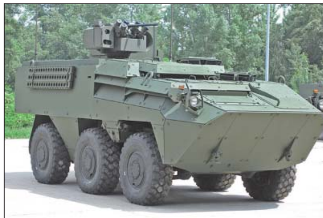
1. ábra. Távirányítású fegyverplatformmal és 12,7 mm-es géppuskával szerelt 6x6-os Pandur páncélozott szállító harcjármű
