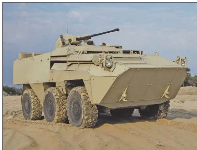
2. ábra. KD-V30-as alacsony profilú toronnyal, 30 mm-es gépágyúval és párhuzamosított 7,62 mm-es géppuskával felszerelt kuwaiti 6x6-os Pandur gyalogsági harcjármű
