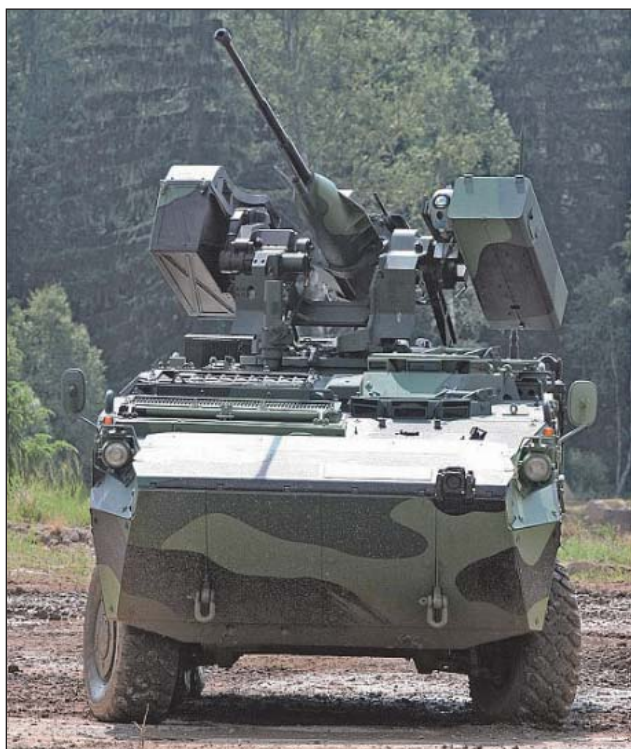
10. ábra. A 8x8-as Pandur gyalogsági harcjármű automata toronnyal és rakéta-konténerekkel
