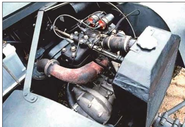
5. ábra. Az első motor. Megfigyelhetők a nagy hűtő és a vastag hűtőfolyadék-csövek. A hengerfejen rögzítve a sebességváltó rudazata, és annak csuklója is láthatóak
