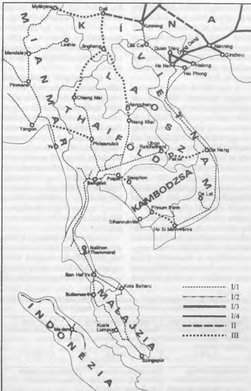
Jelmagyarázat: I – működő vasutak: 1 – 1000 mm-es; 2 – 1067 mm-es, 3 – vegyes nyomtávú; 4 – normál (1435mm) nyomtávú; II – épülő; III – tervezett vasutak.
