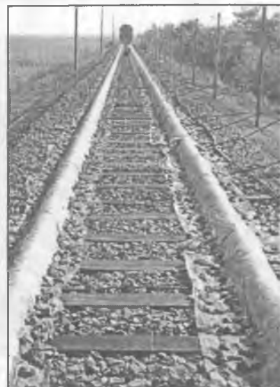
19. ábra A kísérletre előkészített vá-gány sínei hőveszteségének akadályo-zása alumíniumfólia burkolattal
