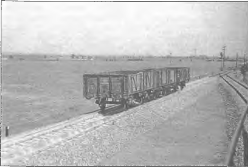
28. ábra A fellemelegített sínekkel rendelkező kísérleti vágányon áthaladó kocsisereg
