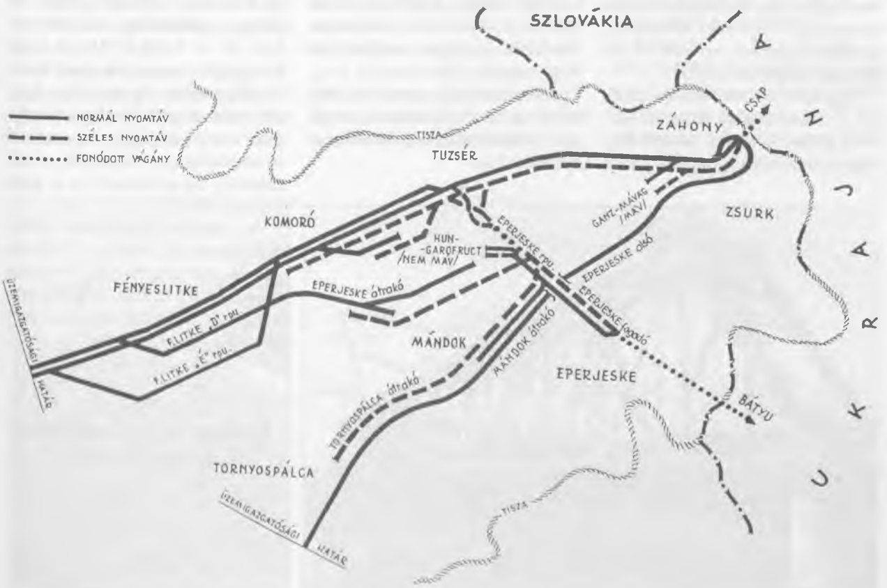
7. ábra: Záhonyi csomópont normál, széles és fonódott vágányai
