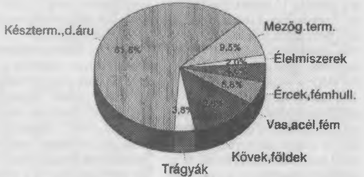
16. ábra A magyar belföldi kombinált fuvarozási áru-potenciál összetétele (a megyék közötti vasúti áruforgalomból levezetve)
