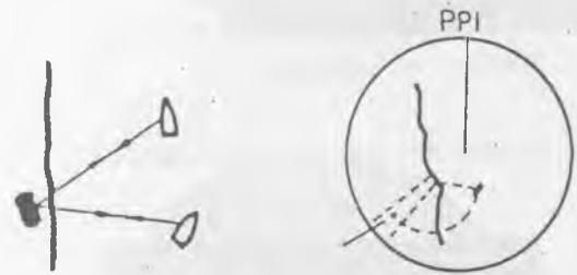
12. ábra Parti céltárgy által okozott indirekt visszhang
