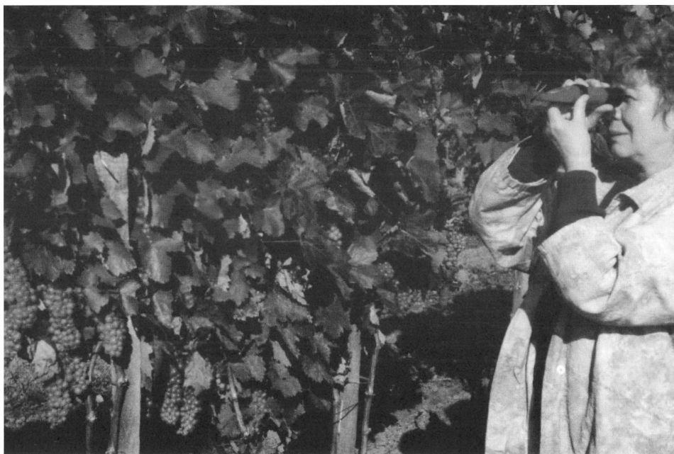
2. kép. A szőlő cukorfokának mérése refraktométerrel 2004-ben Photo 2 Measuring grapes sugar content by refractometer in 2004
