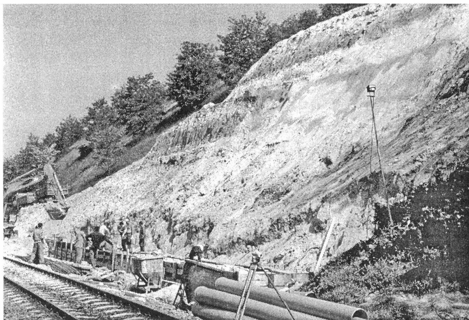
5. kép. A Balatonakarattyai csuszamlás agyagos-márgás szenes vízzáró üledéksorozata csúszási felületekkel (Juhász Á. 1996) Photo 5. Non-permeable clayey-marly coal sequence with slide planes at Balatonakarattya landslide
