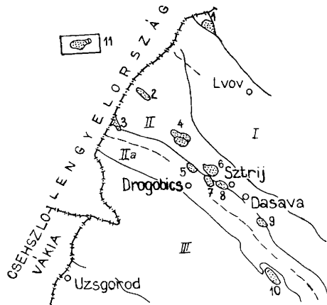
2. ábra. A nyugat-ukrainai jelentősebb földgázmezők elhelyezkedése. Lépték nélküli vázlat. — I = az Orosz tábla délnyugati pereme; II = a Kárpátok előterének külső süllyedékzónája; IIa = a Kárpátok előterének belső süllyedékzónája; III = a gyűrt Kárpátok. Földgázlelőhelyek: 1 = Velikije Moszti; 2 = Szvidnyica; 3 = Hodnovicsi; 4 = Rudki; 5 = Opari; 6 = Bilcsa-Volica; 7 = Ugerszsk; 8 = Dasava; 9 = Grinovka; 10 = Bitkov; 11 = gázlelőhely
