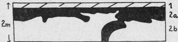
4. ábra. Útbevágás oldalfala, Ny-i részén földfolyással. 1 = termőföld, 2a, 2b = eltérő színű pliocén agyag.
