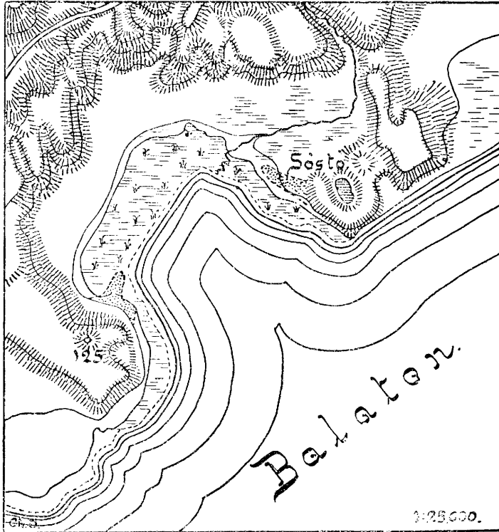
3. ábra. A Kereked-öböl Csopakon, a kétoldali sarkantyús gáttal (pontozva).
